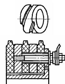
**3.33. Узел контактных колец на пластмассе**
