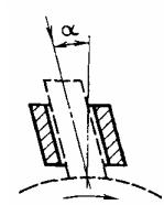
**2.6. Наклонный щеткодержатель для обоих направлений вращения**
