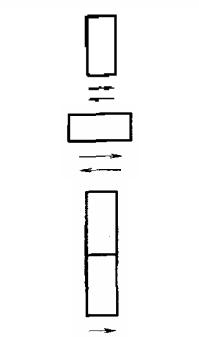
**2.29. Щеткодержатель однообоймный с обоймой типа Т**
