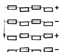
**4.4. Установка щеток со смещением по оси**
